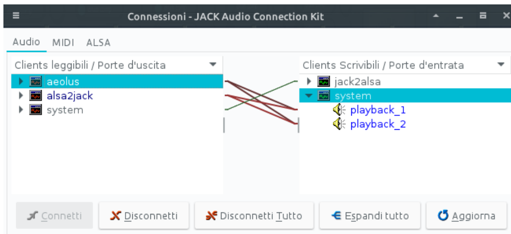
Figura 6: Instaurazione di collegamenti audio con JACK
