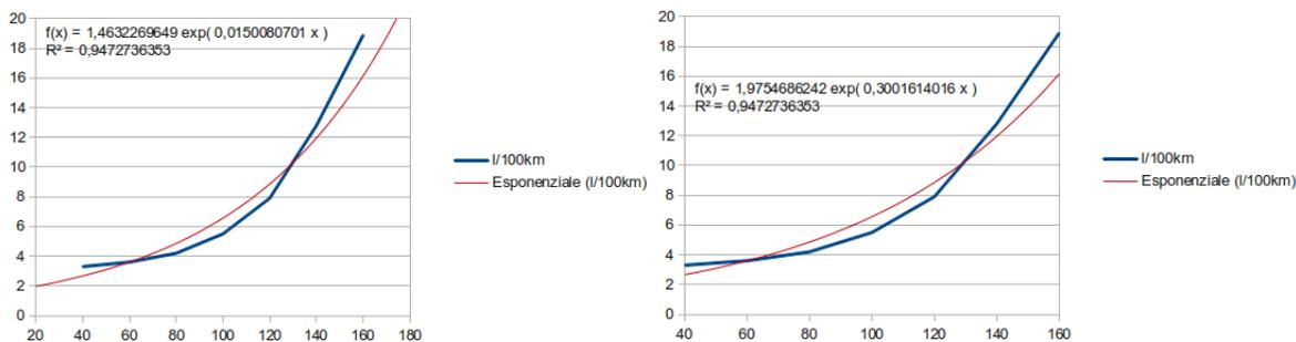
Figura 17: Grafici che illustrano il consumo di carburante in funzione della velocità
